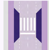
Extensão de meio de quadra
